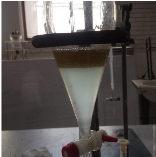
Figura 27. Mezcla del PLS y orgánico (extractante y diluyente).
