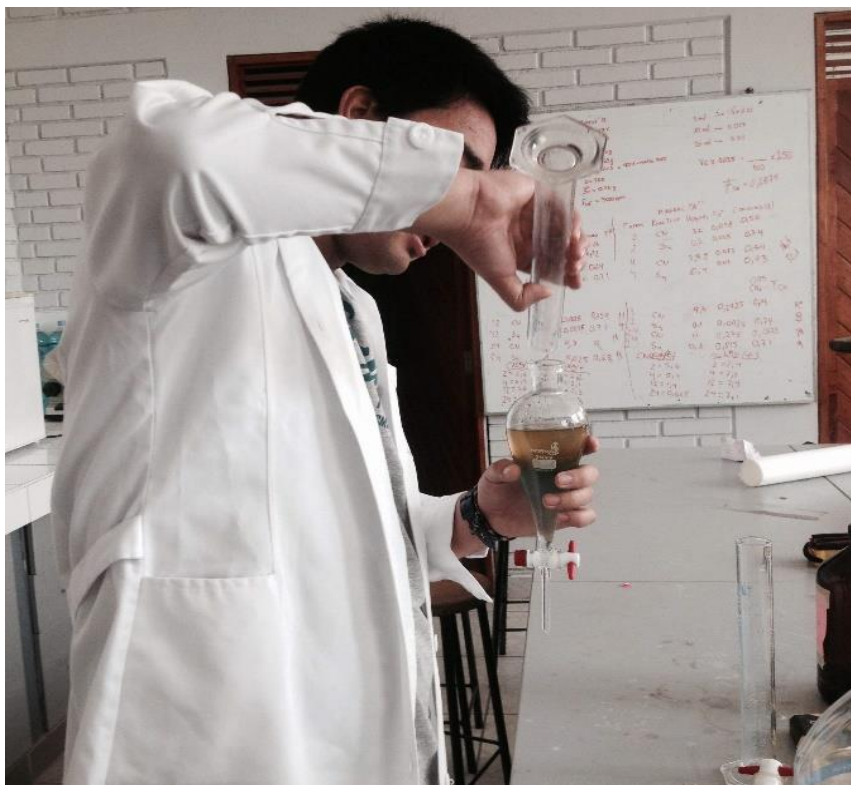
Figura 21. Adición del electrolito pobre con una concentración de ácido de 180 g/l H 2 SO 4 al OC.
