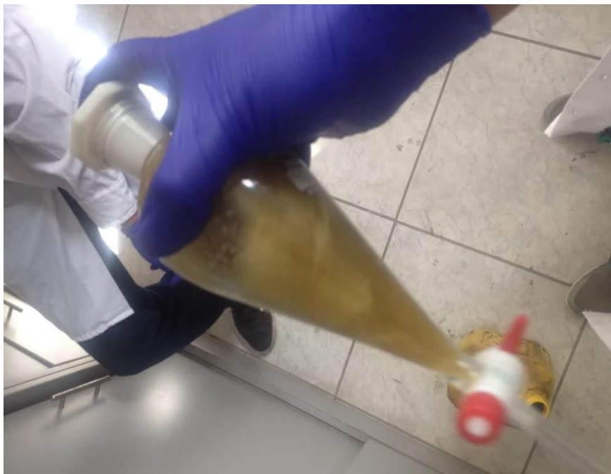
Figura 19. Mezclado del OC con electrolito pobre durante 3 minutos.
