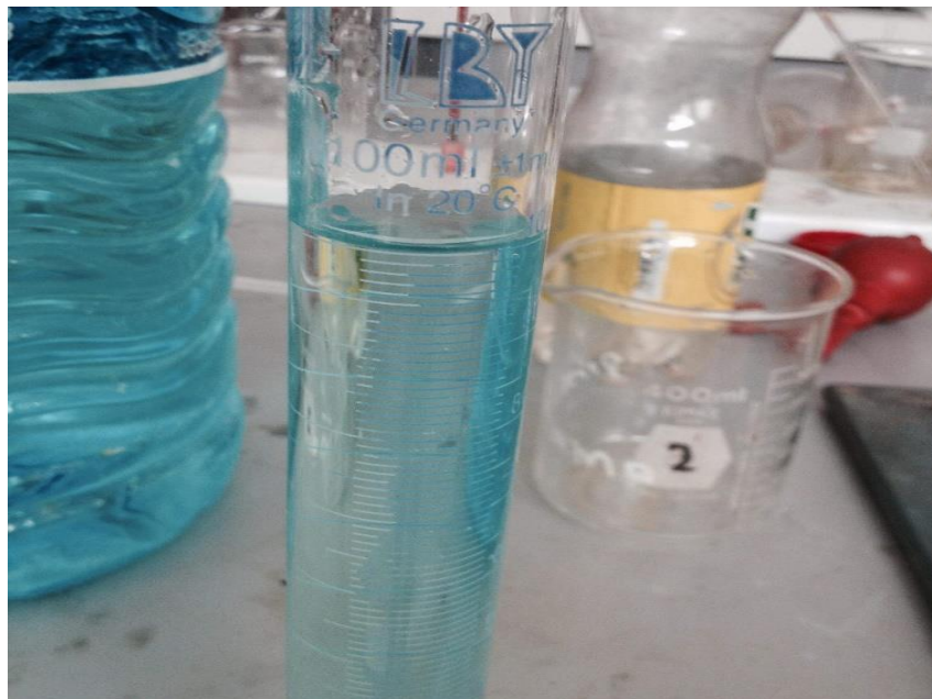
Figura 30. Electrolito descargado utilizado para re-extracción.
