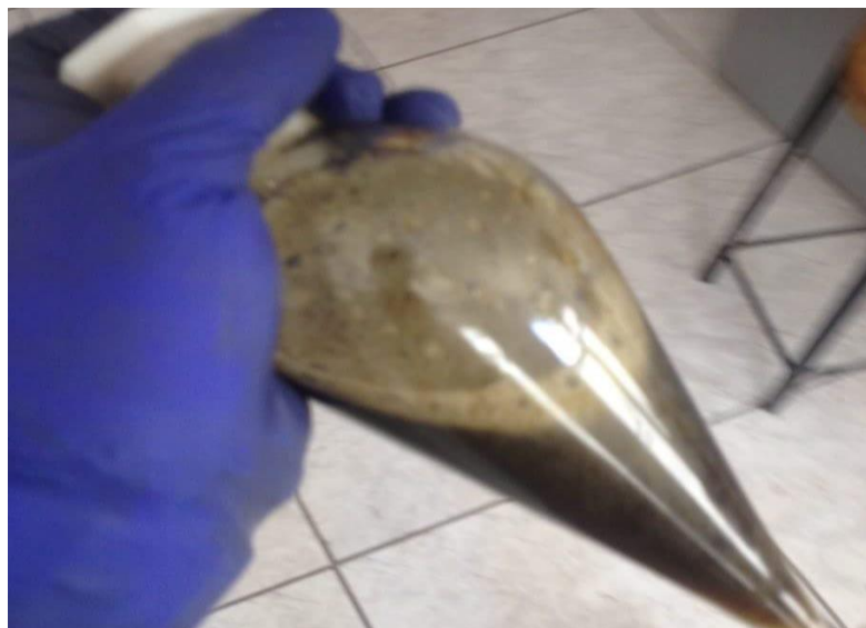
Figura 28. Agitación de la solución PLS y el orgánico.
