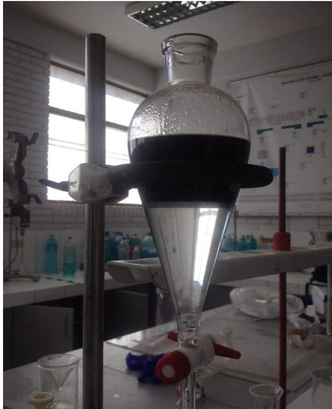
Figura 31. Lavado del orgánico antes de la re-extracción. Fuente: Elaboración propia, 2019.
