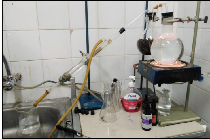
Equipo de Extracción del aceite esencial de botones florales de clavo de olor Syzygium aromaticum por el Método de arrastre del vapor.
