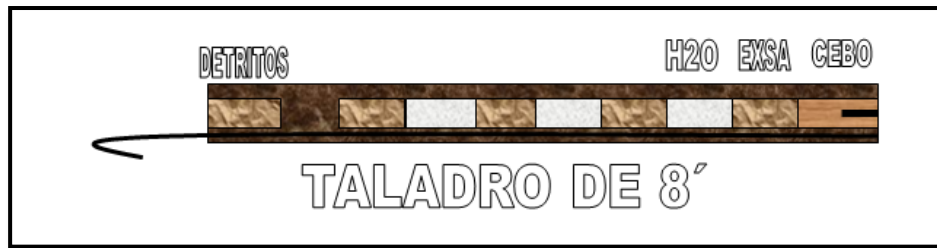
Figura 4.18.: Carga de un taladro.
