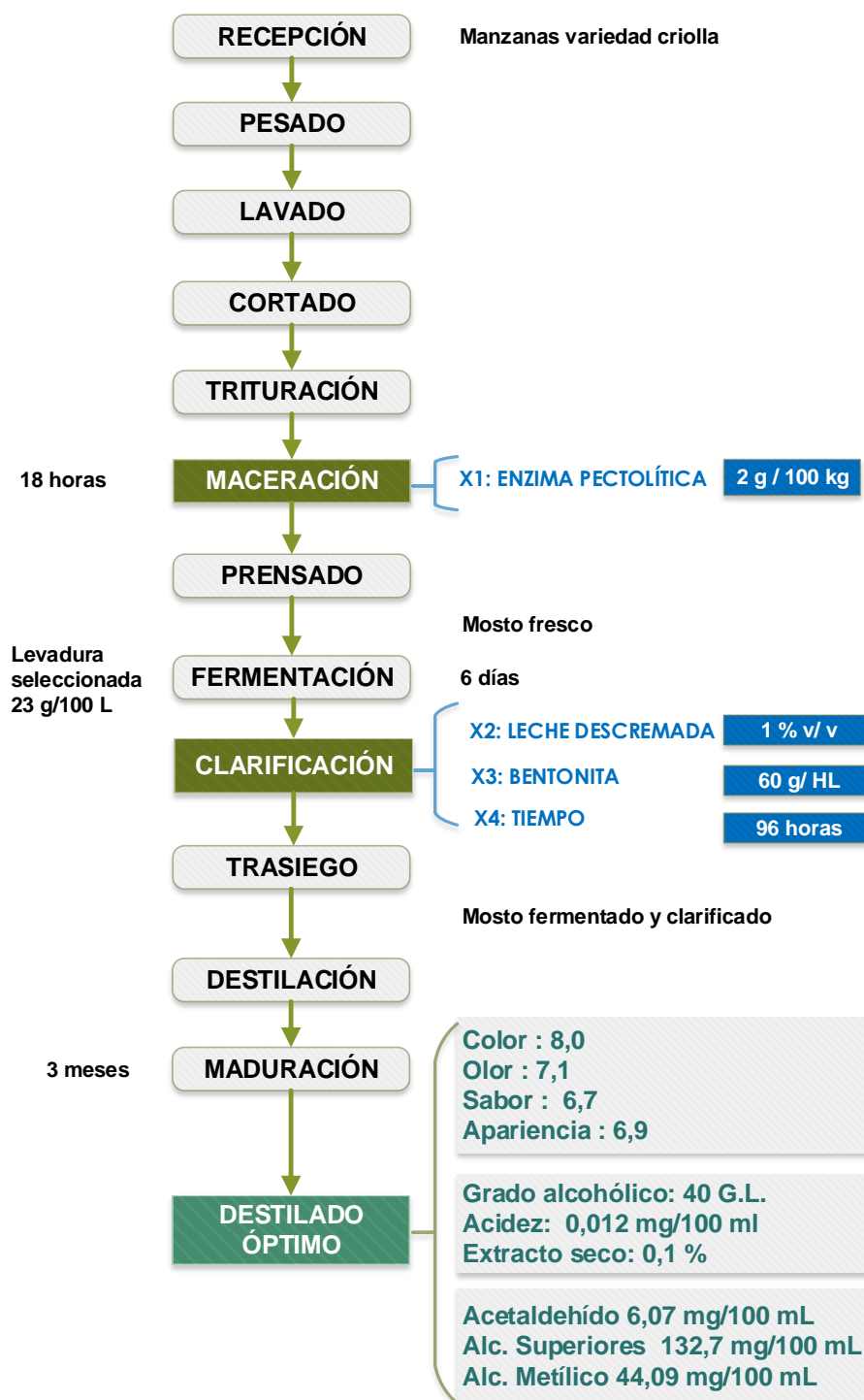
Figura 37. Flujo definitivo en la elaboración de destilado de sidra de manzana variedad criolla de Tarata Fuente: Elaboración propia (2018)
