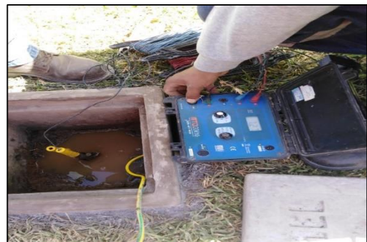
PRUEBAS EN EL TABLERO ELECTRICO Y EN EL POSO A TIERRA
