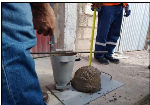
PRUEBA DE SLUMP
