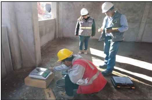
ENSAYO DENSIDAD DE SUELO
