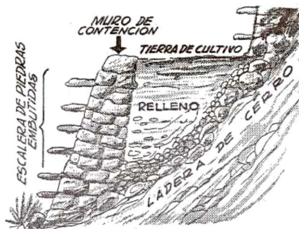
Figura 6. Elementos constructivos del pata – anden
