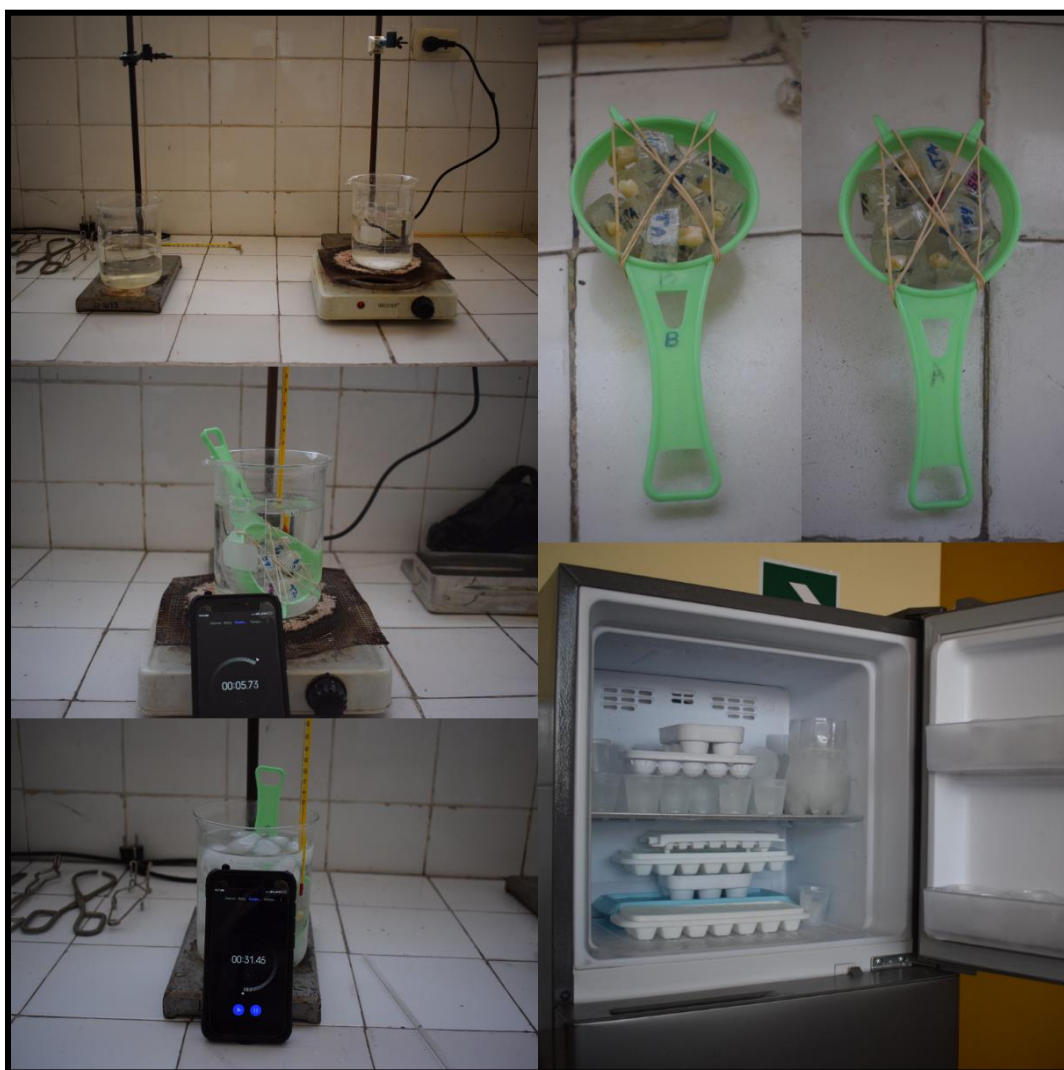
Fig. 08 Termociclado de las muestras en baños de agua a temperaturas de 5^{\circ}\text{C} \pm 2^{\circ}\text{C} y 55^{\circ}\text{C} \pm 2^{\circ}\text{C} por 1000 ciclos de 1 minuto cada uno, en el laboratorio de Química General de la UNJBG.
