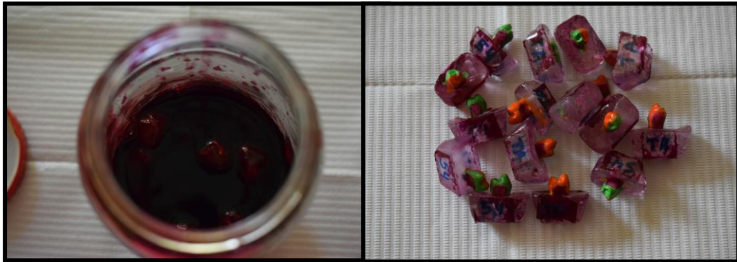
Fig. 09. Muestras sumergidas en una solución acuosa de pigmento consistente en fucsina básica al 0.5% por 24 hrs.
