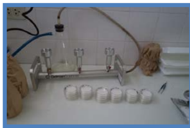
Equipo de filtración de membrana
