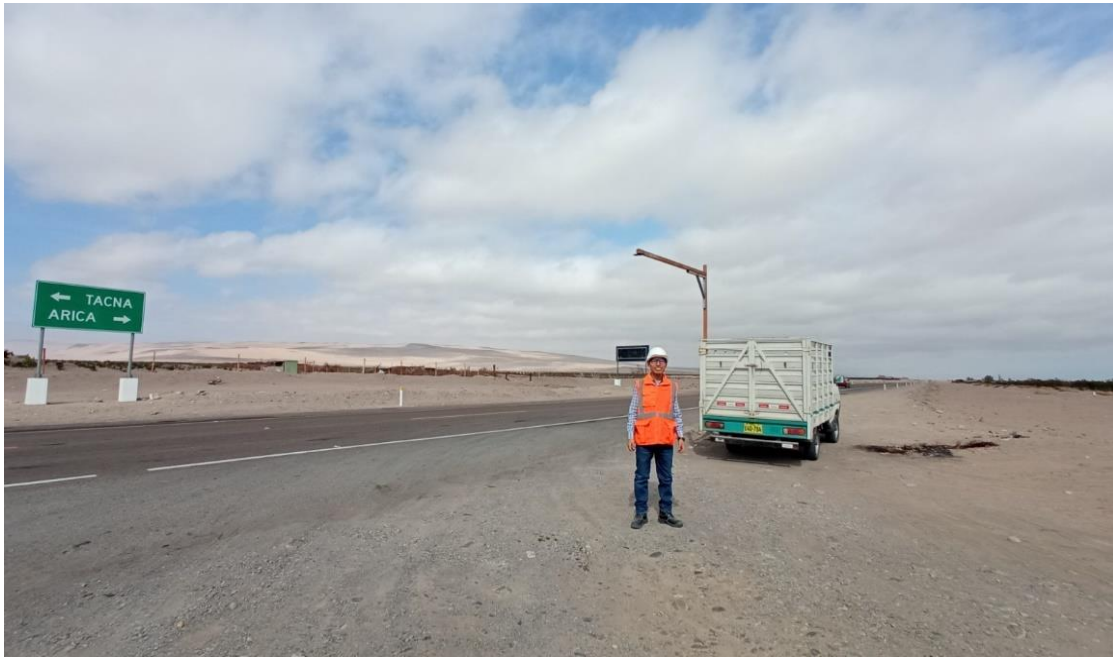
Fotografía 5. Vehículo utilizado para la colocación de la cámara digital en una altura ideal para capturar imágenes del ancho de la calzada para evaluación PCI.
