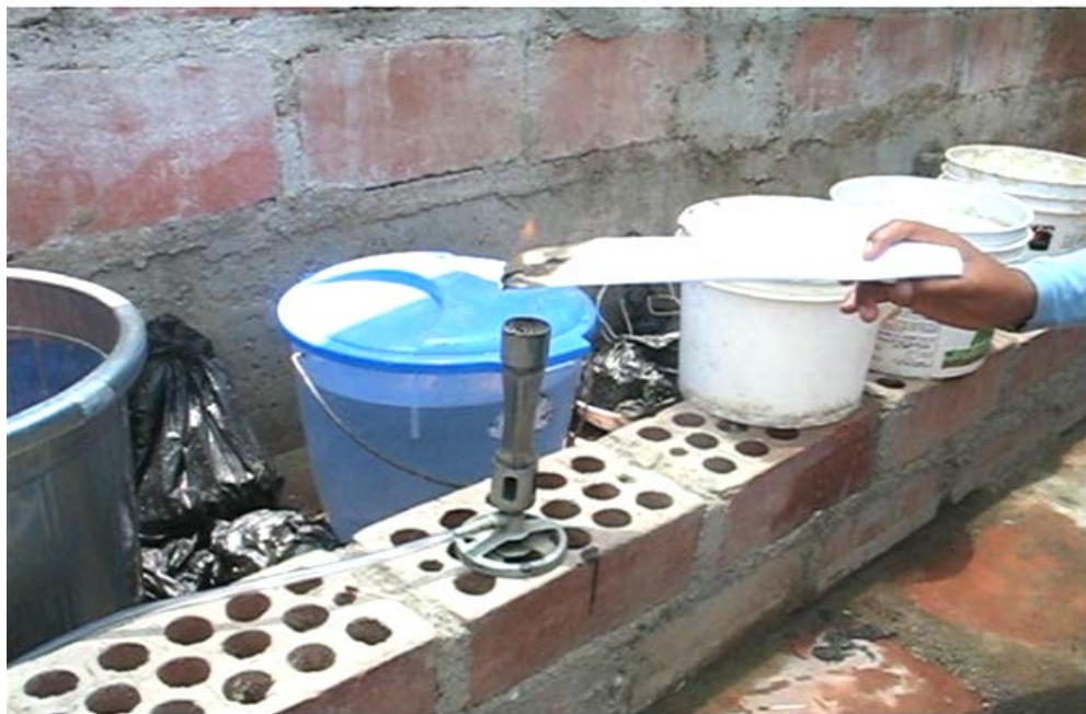
ANEXO 20: Biogas obtenido, probado en un mechero bunsen
