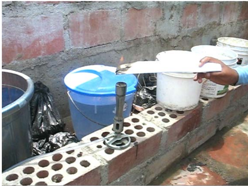
Foto 07: Biogas obtenido y corroborado cuando se prendió fuego.
