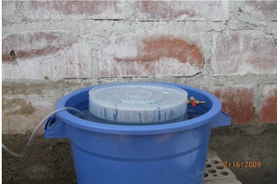
ANEXO 11: Gasómetro del biodigestor utilizado
