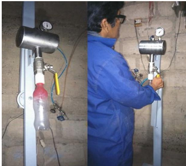
Figura 12. Sistema de carbonatación
