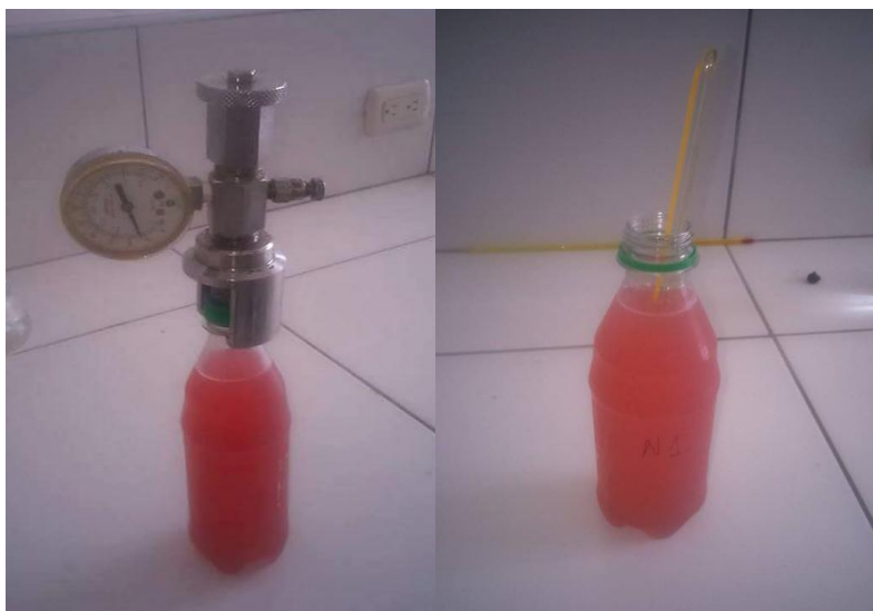
Figura 13. Medición de la presión y temperatura para el cálculo del volumen de anhídrido carbónico
