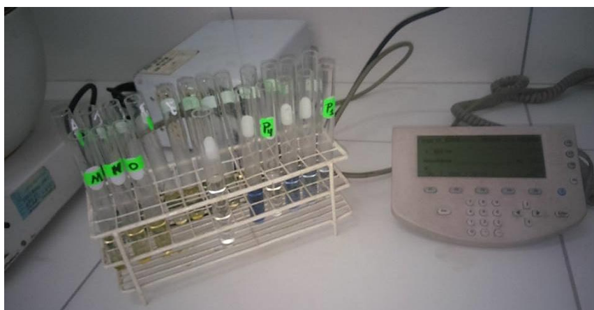
Figura 14. Medición la absorbancia en la determinación de compuestos fenólicos
