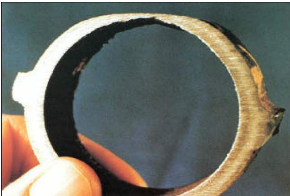
Figura 5. Severa pérdida de metal a lo largo de la corona del tubo (Herro & Port, 1997)
