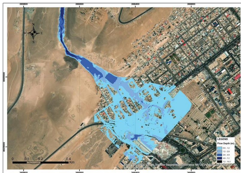
Figura 9. Profundidades máximas de flujo de la recreación del evento del 21 de febrero de 2020
