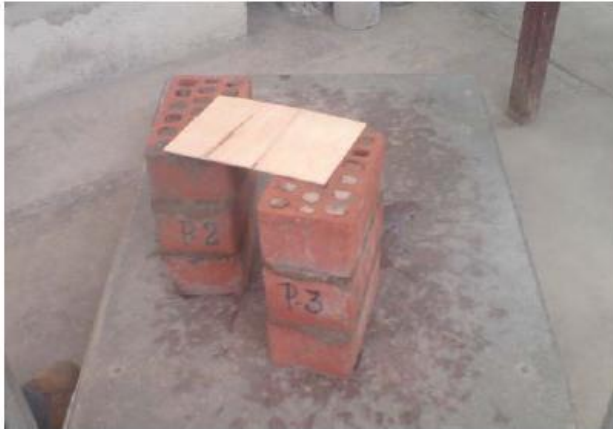
Testigos de Pilas para la prueba a compresión
