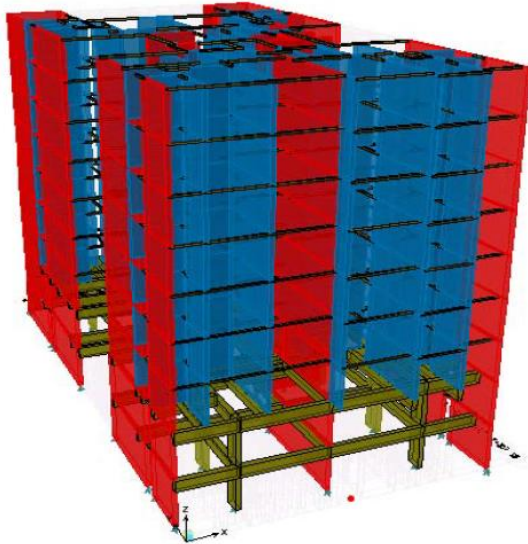
Figura 45 Vigas de Acoplamiento
