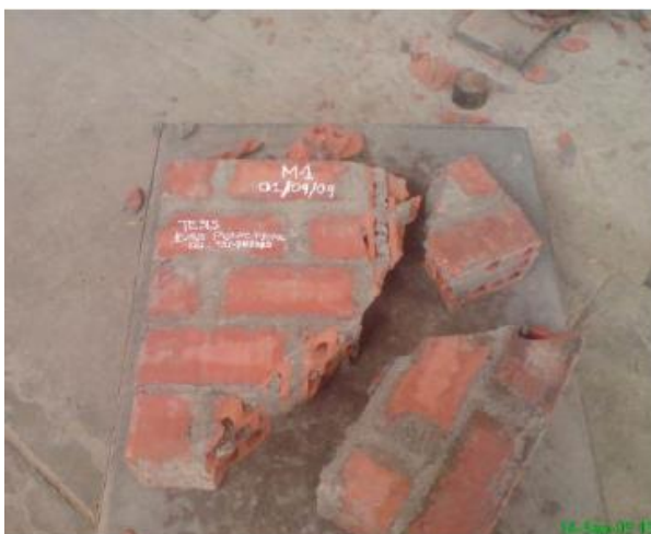
Ensayos realizados para determinar la resistencia al corte de la albañilería
