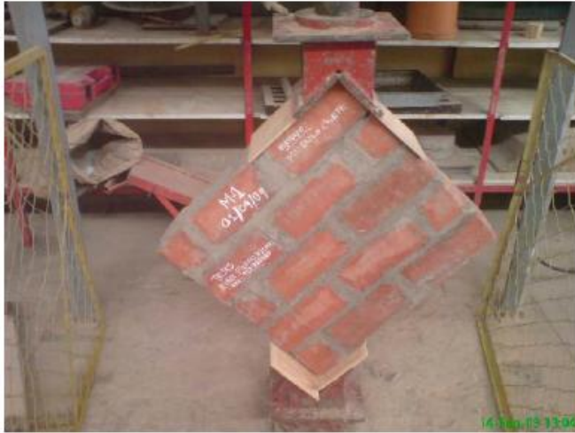
Murete a ser ensayado a tracción diagonal
