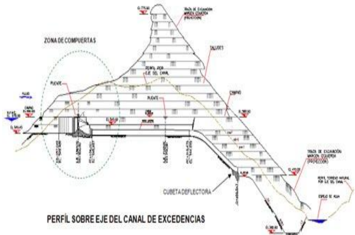
FIGURA 12. Vista de las obras de excedencias. El Cajón
