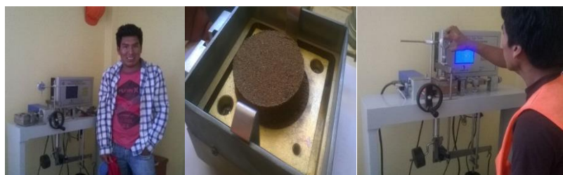
Figura 3. 7: Ensayo de corte directo de las muestras de suelo. Fuente: Elaboración propia
