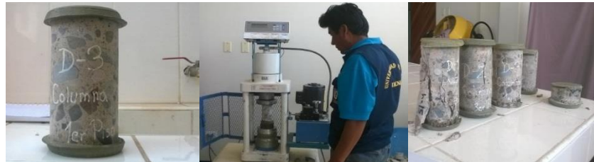
Figura 3. 6: Capeo de probetas y respectivo ensayo de rotura. Fuente: Elaboración propia
