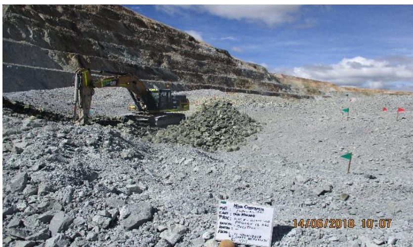
Muestreo de Material Enrocado Estructural en Tajo Constancia
