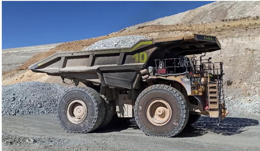
Camión minero CAT 793F cargado (peso de carga 228 t.) Fuente: Área de Calidad Stracon – Mina Constancia (2018)
