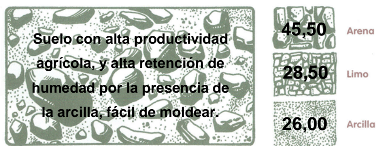
Figura 32. Suelo Franco Arcilloso
