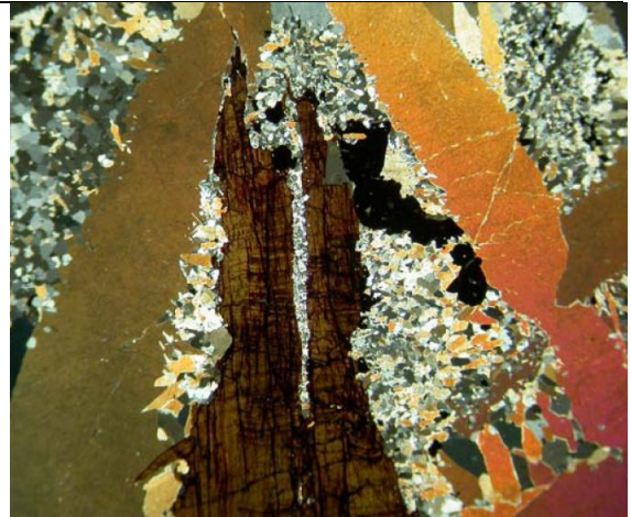
Foto N° 27, Cristales de cuarzo y hübnerita hipidiomórficos de primera generación en matriz de cuarzo asociado con la segunda generación. observe la fractura en la hübnerita relleno de cuarzo. muestra M3, objetivo de 2,5 x, LR, N //.
