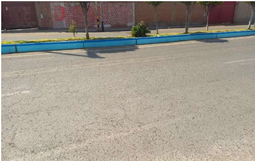
Unidad de muestreo U54 piel de cocodrilo de severidad media
