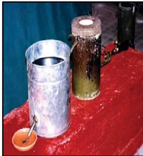
Figura 15. Retorta y calentamiento cerrado
