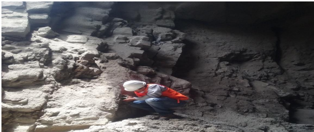
JM.I06_Medición de Buzamiento y Dirección de buzamientos, a los sistemas de familias de fracturas, del portal de salida del Túnel Chacahuaro II.
