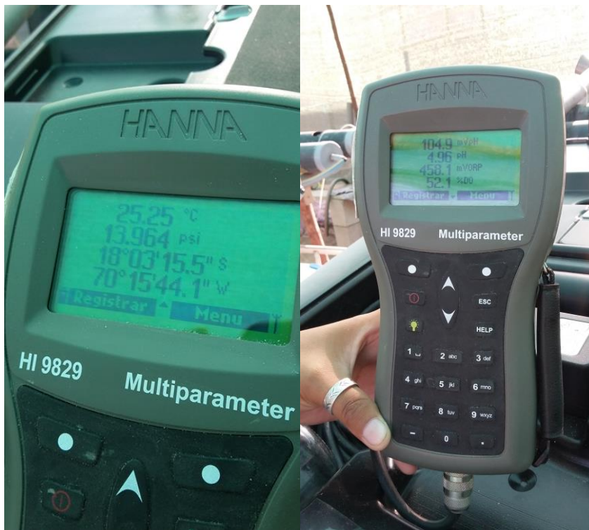
Figura 25: Multiparámetro utilizado en el muestreo de la calidad
