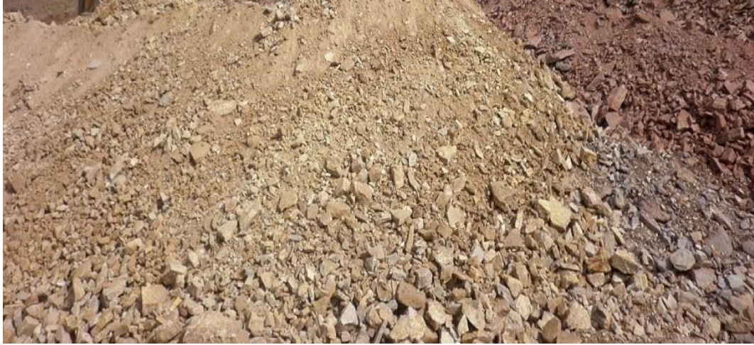
Figura 26: Muestra el resultado del disparo de la malla 2 x 2, con clastos menores a 15 cm, mirando al oeste
