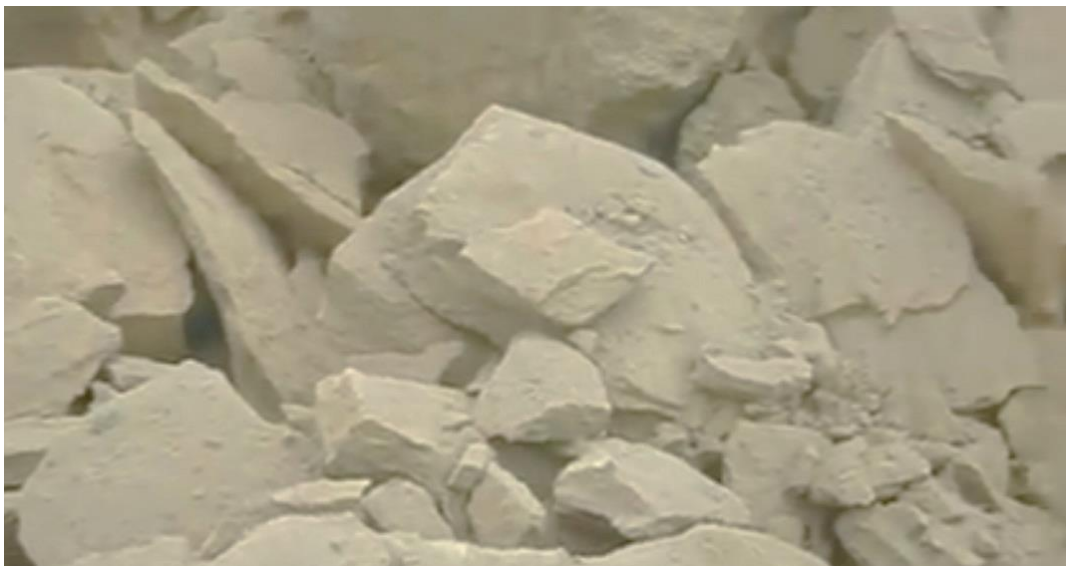
Figura 21: Mirando hacia el oeste, muestra los fragmentos más grandes (40 cm x 30 cm x 30 cm), considerado como un mal disparo Fuente: Propia
