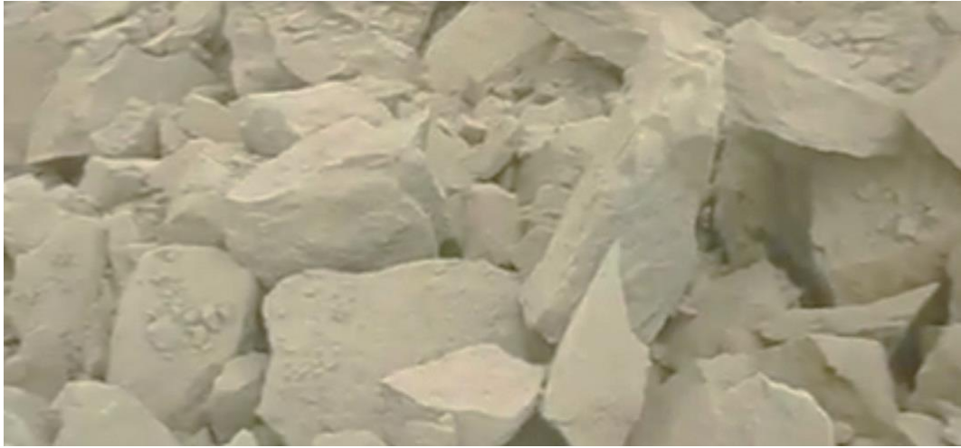
Figura 22: Mirando hacia el sur, muestra los fragmentos más grandes (40 cm x 30 cm x 30 cm), considerado como un mal disparo Fuente: Propia
