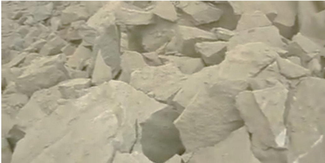
Figura 20: Mirando hacia el norte, muestra los fragmentos más grandes (40 cm x 30 cm x 30 cm), considerado como un mal disparo Fuente: Propia
