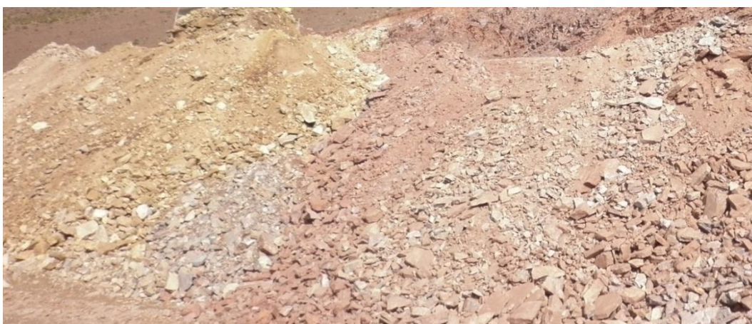
Figura 25: Muestra el resultado del disparo de la malla 2 x 2, con clastos menores a 15 cm, mirando al norte Fuente: Propia
