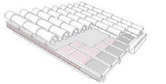
INCORPORACIÓN DE AISLANTE TÉRMICO EN LA CUBIERTA PARA REDUCIR LA TRANSFERENCIA DE CALOR, MEJORAR LA EFICIENCIA ENERGÉTICA Y MANTENER CONDICIONES DE CONFORT TÉRMICO EN EL INTERIOR
