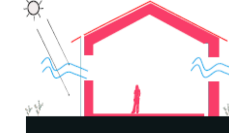
ILUMINACIÓN Y VENTILACIÓN CRUZADA A TRAVÉS DE VANOS
