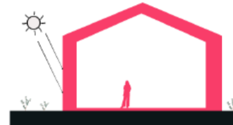
TECHO DISEÑO DE CUBIERTA A DOS AGUAS COMO ESTRATEGIA PARA LA EVACUACIÓN EFICIENTE DEL AGUA DE LLUVIA
