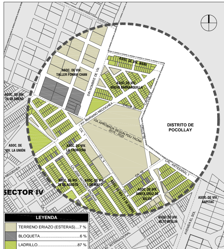
Figura 29. Estado de edificación Fuente: Elaboración propia.
