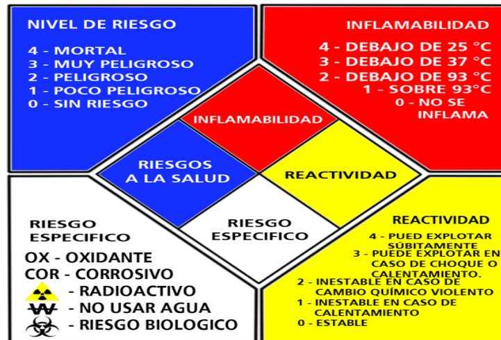
Figura N° 1. Diamante de Materiales Peligrosos NFPA 704
