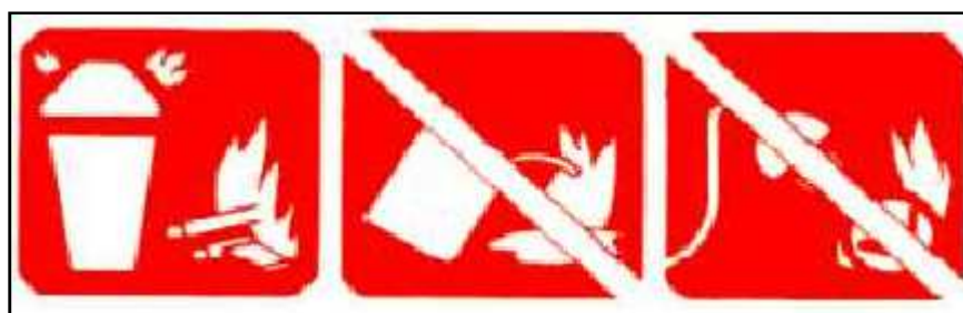
Figura N° 14: Extintores para Fuego Clase “A”
