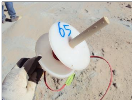
Figura 107. Herramienta de madera para primar.
