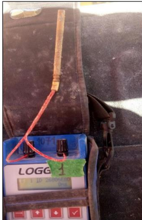
Figura 50. Reconocimiento del detonador electrónico (I-kon) encontrado en el Logger.
