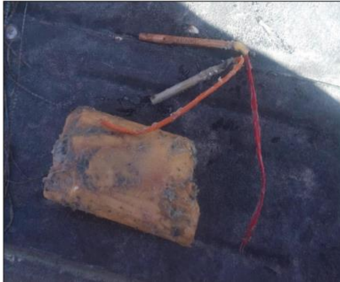
Figura 47. Vista del booster con los detonadores.
