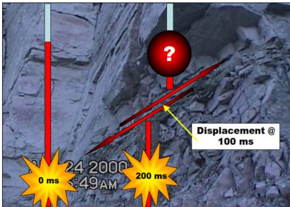
Figura 12. Corte debido a desplazamiento de estructuras geológicas.
