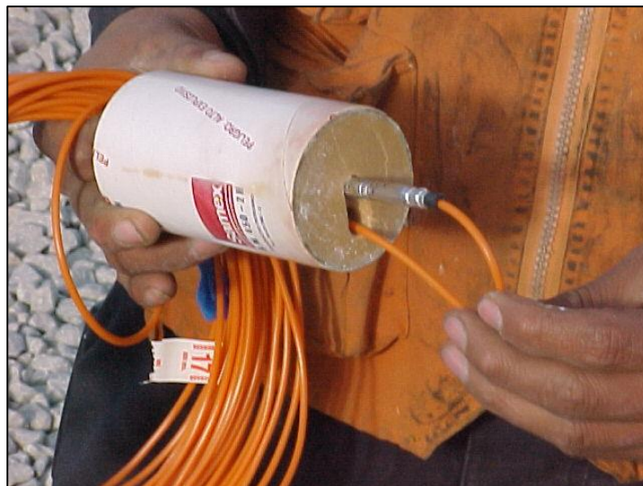
Figura 15. Primado de detonador pirotécnico con booster.
