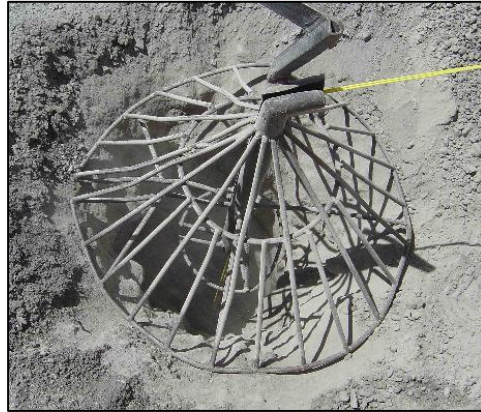
Figura 113. Rejilla cónica para poder filtrar el sobre tamaño existente en el cutting.
