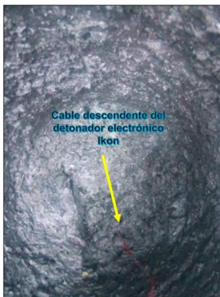
Figura 45. Vista del cable del detonador electrónico (I-kon) encontrados en el fondo del taladro.
