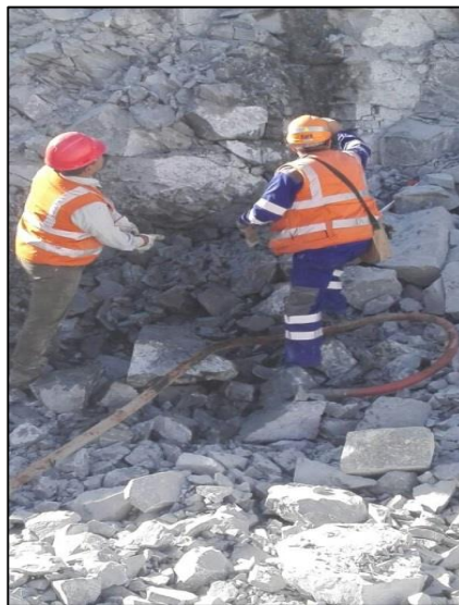
Figura 56. Identificación de la columna de carga del taladro.
