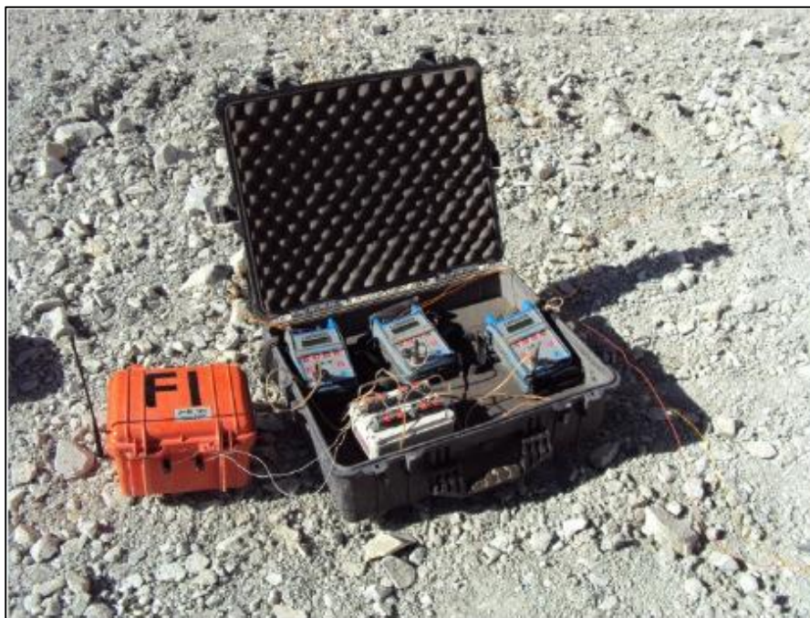
Figura 117. Maleta pelican utilizada como herramienta de protección para equipos.
