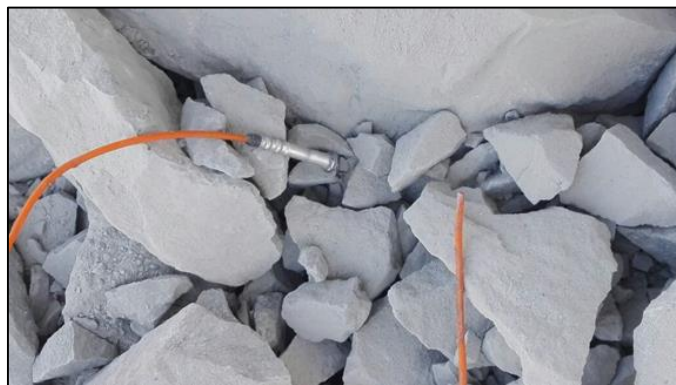
Figura 57. Retiro del fulminante del fanel.
