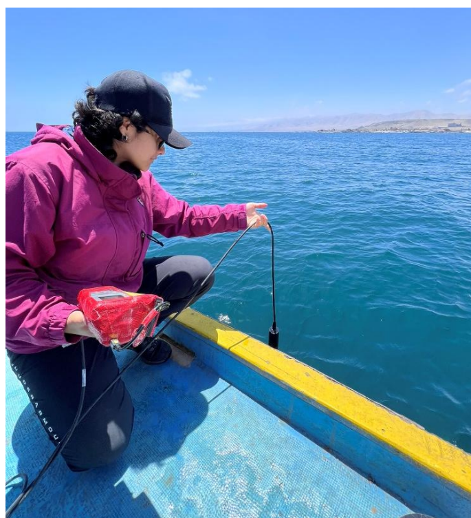
Nota. Medición de parámetros ambientales con multiparámetro YSI ProQuarter
