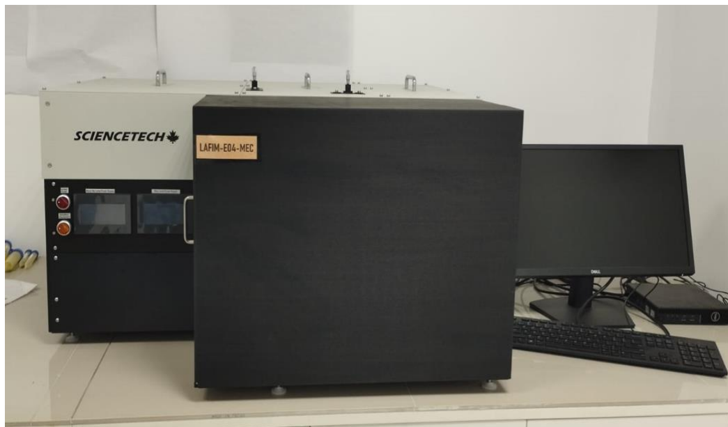
Figura 18. Simulador solar para analizar eficiencia de células Solares sensibilizadas por colorantes.
