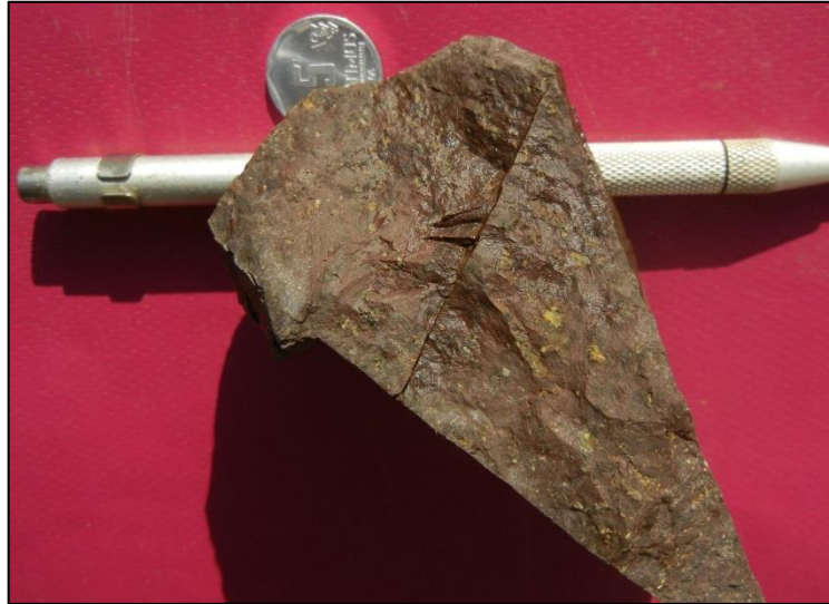
Foto N° 05: Tobas de cristales y cenizas de composición andesítica, matriz fina violácea, presenta magnetita.
