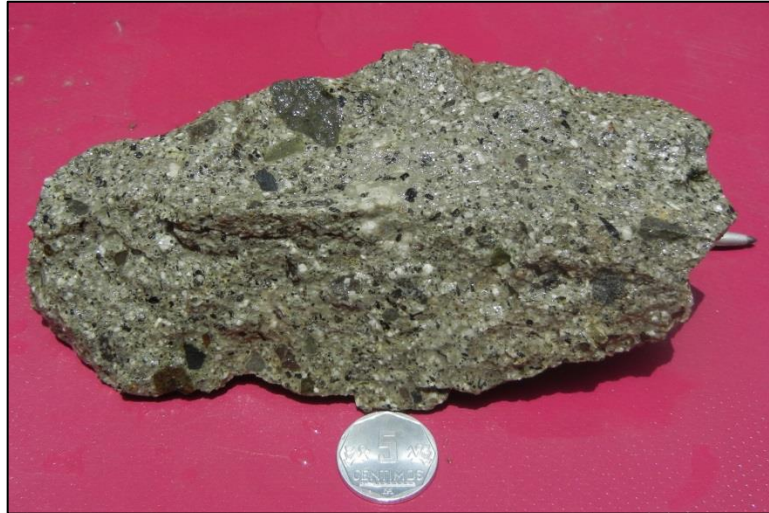
Foto N° 04: Tobas de cristales, líticos y cenizas de composición dacítica, los líticos corresponden (lutitas, limolitas y vulcanitas).
