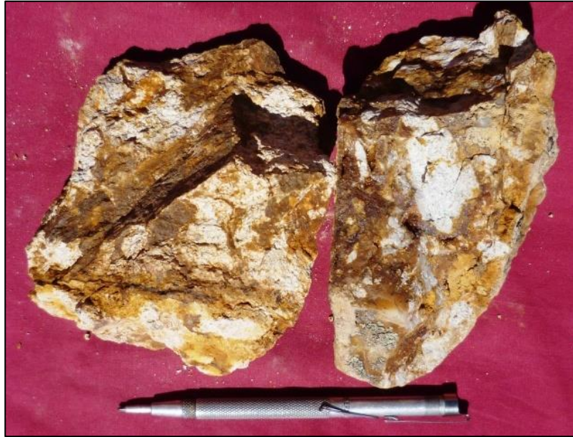
Foto N° 07: Dacita porfirítica alterada con presencia de goethita-hematita-jarosita.
