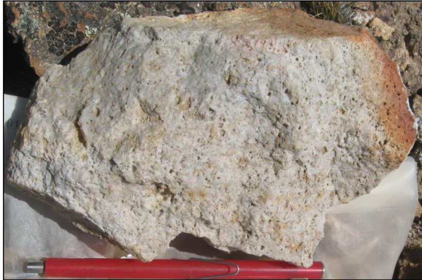
Foto N° 20: La dacita porfirítica presenta alteración moderadamente a fuertemente silicificada.
