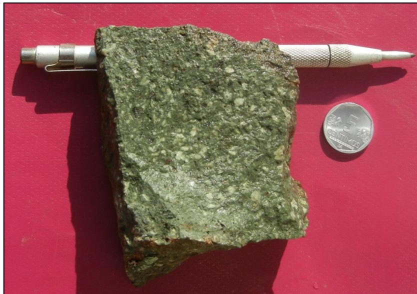
Foto N° 25: dacita porfirítica, con un ensamble de alteración de (cuarzo-Magnetita-Calcita-clorita).
