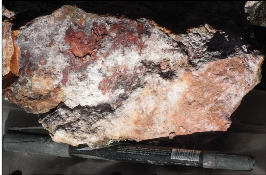
Foto N° 21: Se observa la alteración argílica avanzada (cuarzo-alunita).
