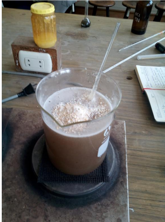
Figura 24: Sacarificación del almidón. Fuente: Propia.
