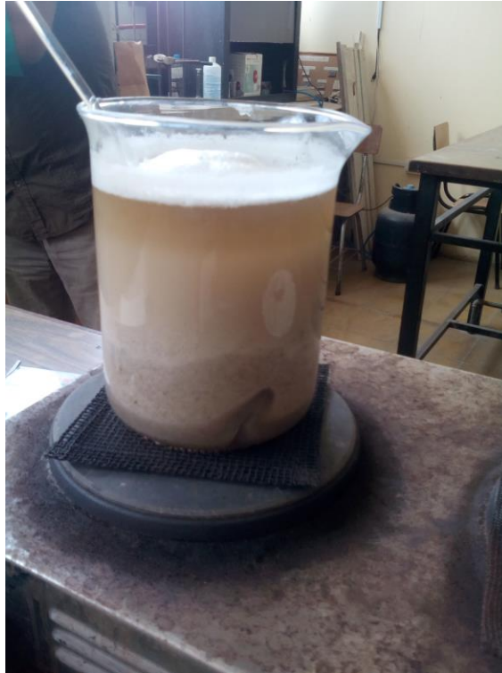
Figura 22: Licuefacción del almidón. Fuente: Propia.
