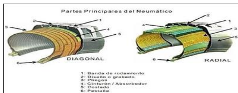
Figura 7 Partes principales del neumático
