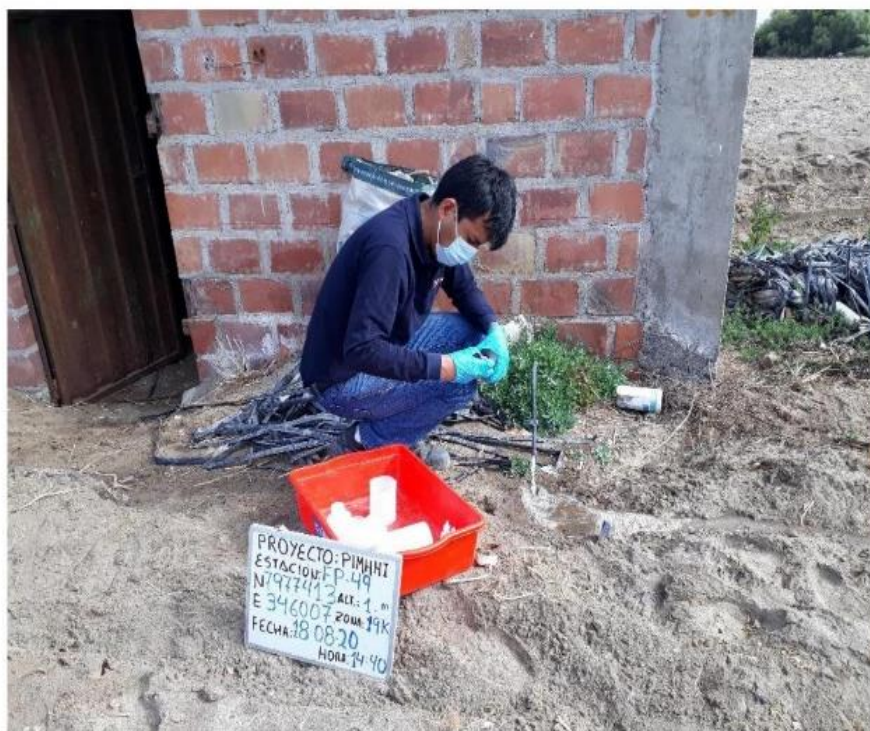
Fotografía 3. Sellado y etiquetado de las muestras de agua en botellas de polietileno.
