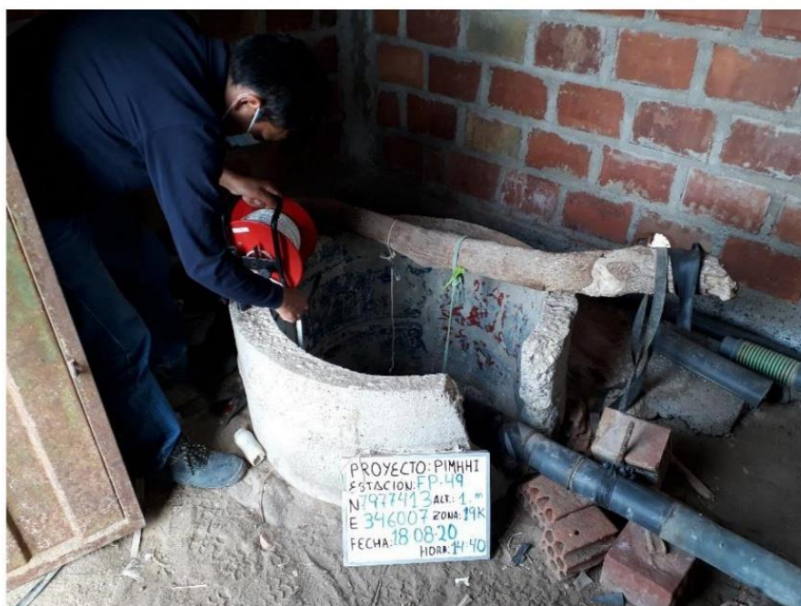
Fotografía 2. Medición del nivel del agua en el pozo FP-49, ubicado en el sector Los Palos cerca al litoral.
