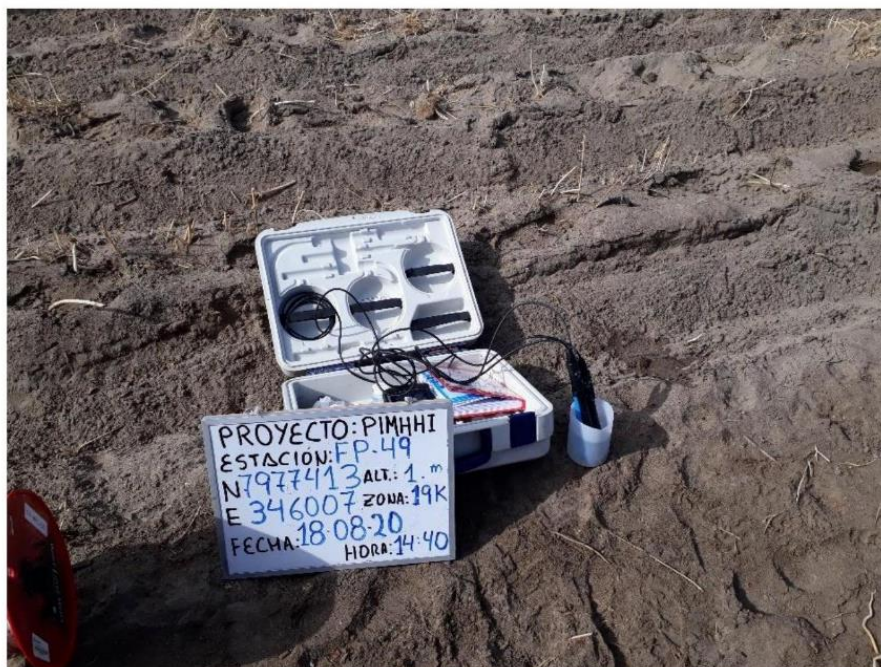
Fotografía 1. Medición de parámetros de conductividad eléctrica (CE) y ph in situ en el pozo FP-49, ubicado en el sector Los Palos cerca al litoral.
