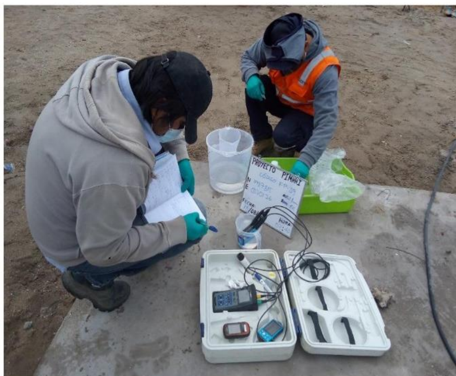
Fotografía 6. Medición de parámetros de conductividad eléctrica (CE) y ph in situ en el pozo FP-39, ubicado cerca al sector Los Chasquis.
