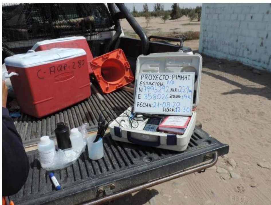
Fotografía 8. Medición de parámetros de conductividad eléctrica (CE) y ph in situ en el pozo FP-33, ubicado en el sector de Magollo.
