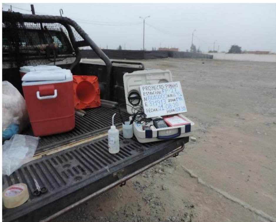
Fotografía 12. Medición de parámetros de conductividad eléctrica (CE) y ph in situ en el pozo FP-27, ubicado en el Parque Perú.
