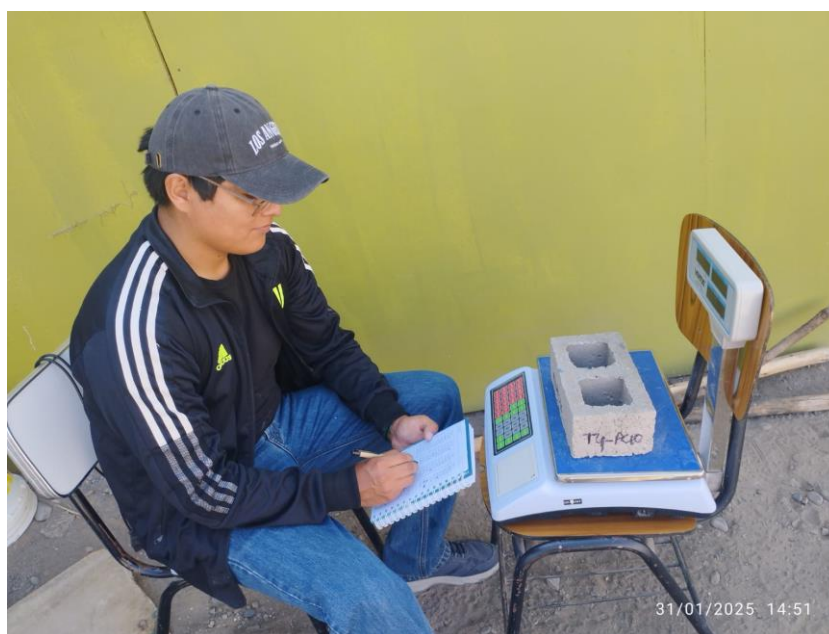
Pesado de ladrillos
