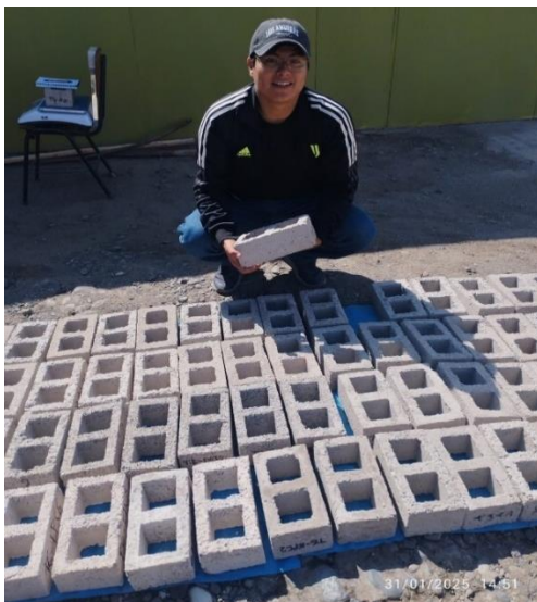
Ladrillo después de 28 días de curado
