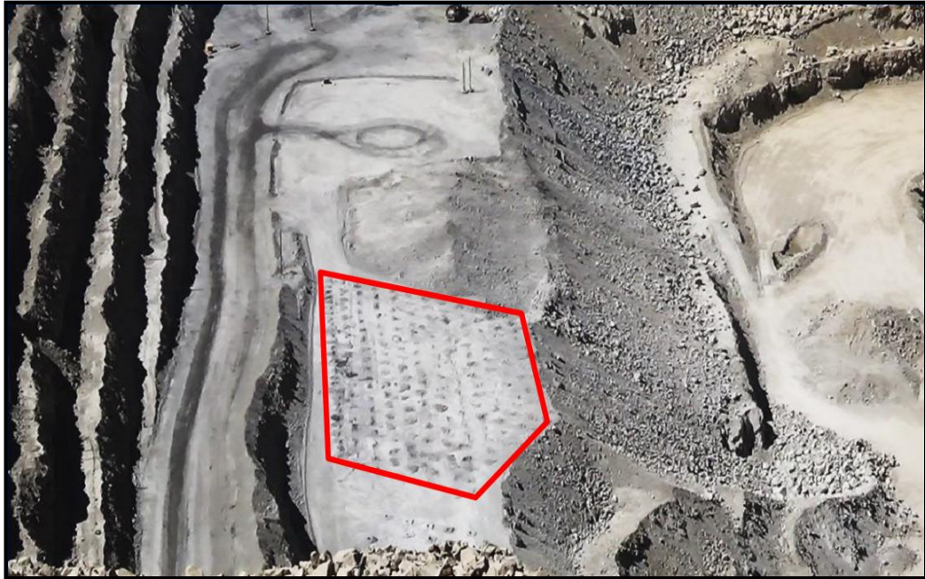
Figura 40. Proyecto de voladura 2785 011 Fuente: Southern Perú, mina Toquepala, 2012.
