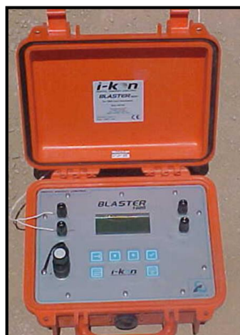
Figura 22. Blaster – Iniciador de voladura Fuente: Departamento de perforación y voladura, mina Toquepala, 2012.
