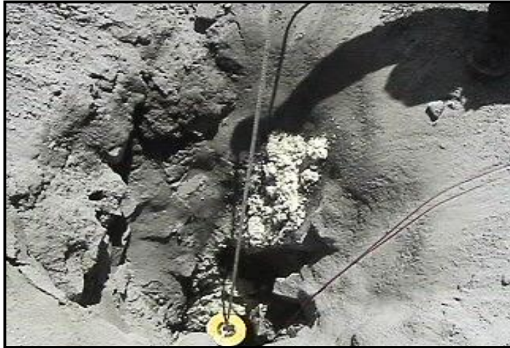
Figura 8. Collar del taladro con material fragmentado Fuente: Southern Perú, mina Toquepala, 2012.
