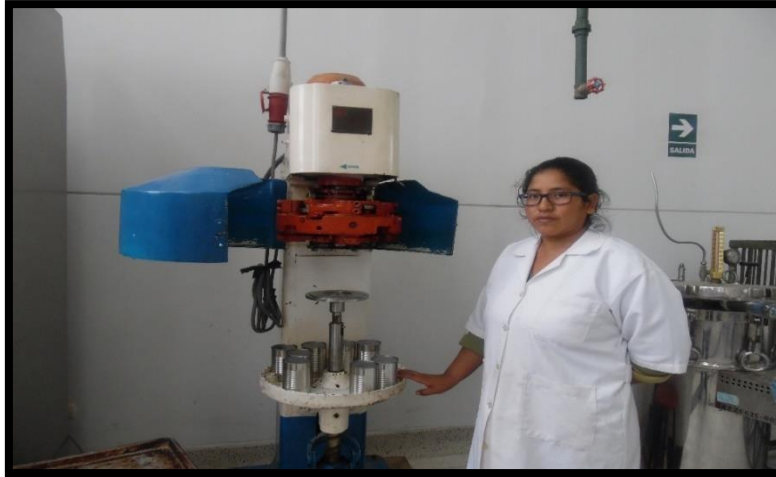
Foto N° 03: Sellado de conservas
