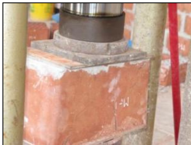
Fig. 19 Falla de la unidad Blocker II por compresión
