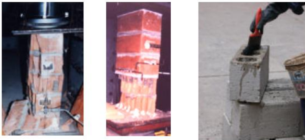
Fig. 3: Fallas frágiles en unidades con más de 30% de huecos (izq, centro) y bloques de concreto artesanales usados en Tacna (der.)
