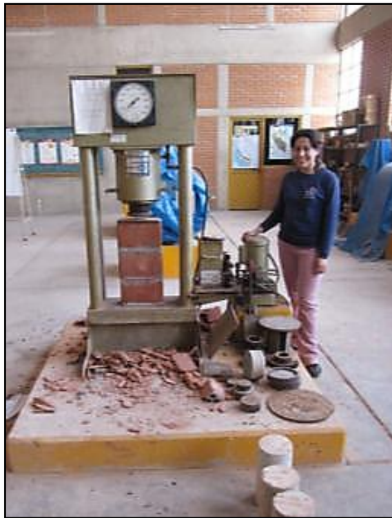
Fig. 23 Disposición para ensayo de compresión axial de pilas de ladrillo
