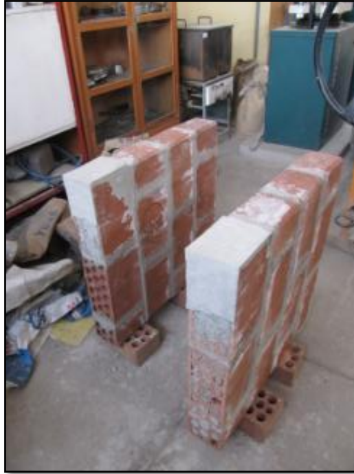
Fig. 30 Capeado de vértices de muretes en laboratorio UNSA
