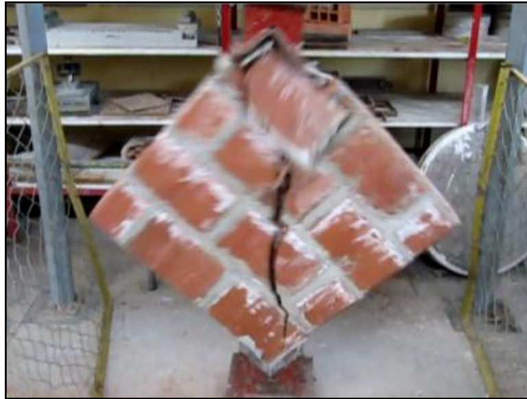
Fig. 32 Falla por compresión diagonal del murete con Blocker II
