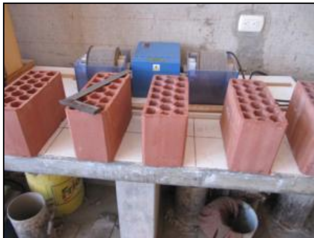
Fig. 8 Ensayo de Porcentaje de ranuras en unidades Blocker II
