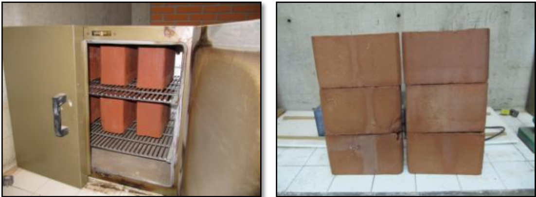
Fig. 15, Fig. 16: Ensayo de Eflorescencia: Secado de los ladrillos en horno por 24 horas, la eflorescencia de los ladrillos Blocker II se hace perceptible a la vista.
