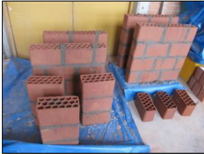
Fig. 22 Pilas y muretes de ladrillos Blocker II terminados
