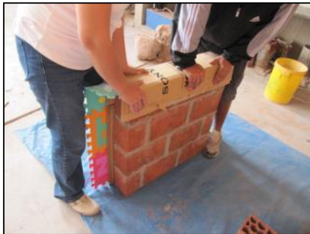
Fig. 28 Embalaje de muretes para transporte a lugar de ensayo
