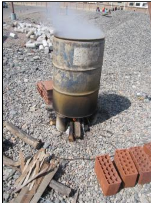
Fig. 11 Ensayo de absorción máxima: los ladrillos saturados se ponen a cocción para mayor saturación
