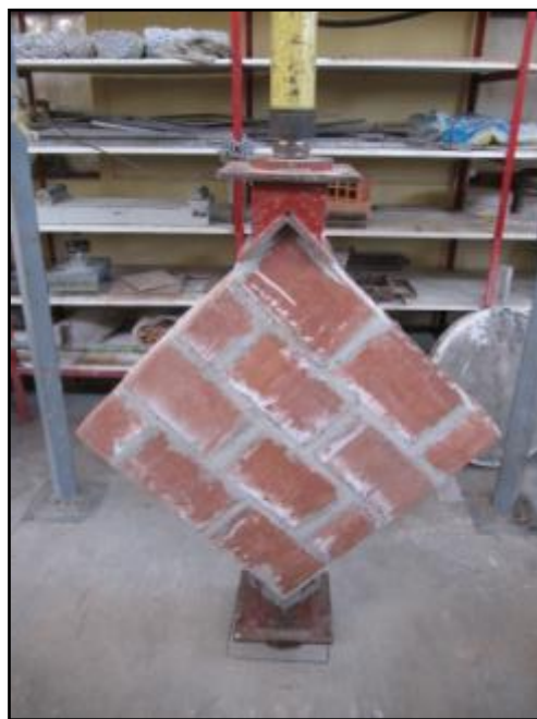
Fig. 31 Disposición del murete para ensayo de compresión diagonal
