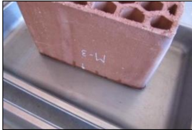
Fig. 9 Ensayo de succión de agua en los Blocker II
