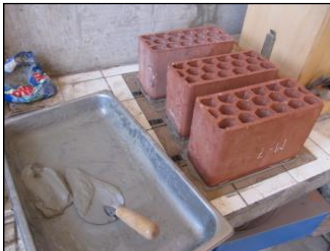
Fig. 17 Capeo de las unidades Blocker II para el ensayo de Resistencia a la compresión
