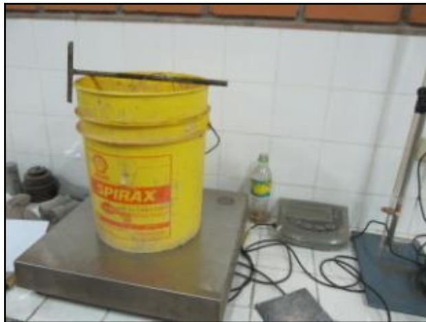
Fig. 14 Ensayo de densidad: Articulo para poder calcular el peso sumergido de los ladrillos saturados
