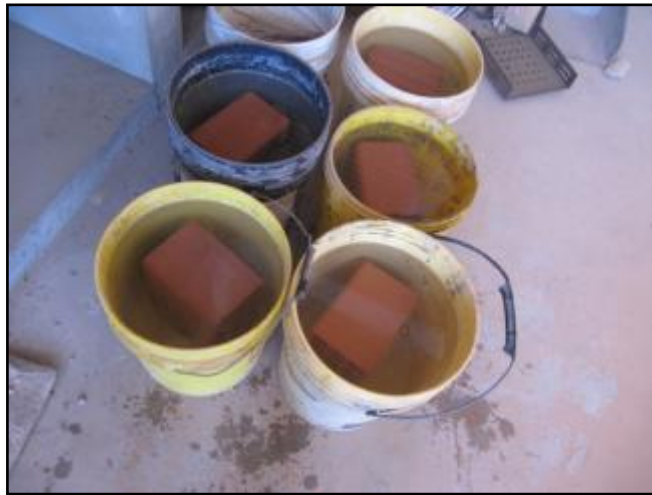
Fig. 10 Ensayo de absorción: se colocan los ladrillos en remojo por 24 horas
