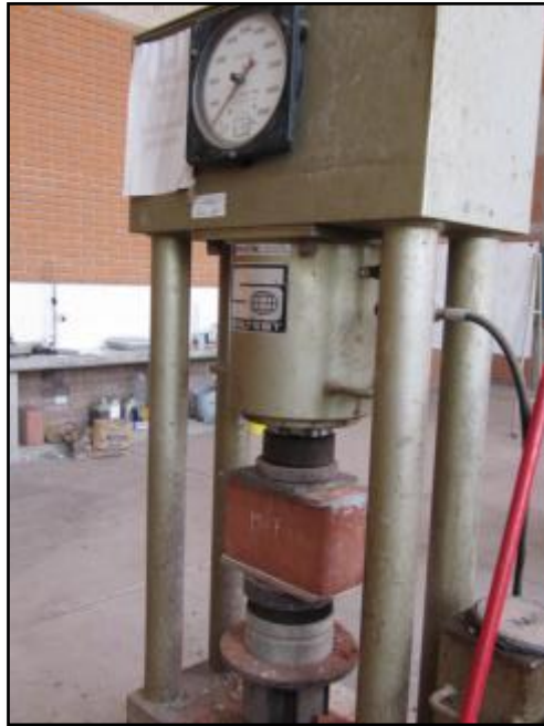
Fig. 18 Ensayo de resistencia a compresión de las unidades Blocker II
