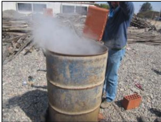
Fig. 12 Ensayo de densidad: Ladrillos Blocker II dejados en ebullición para saturación máxima
