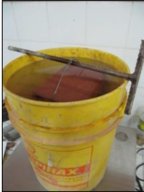
Fig. 13 Ensayo de densidad: Medición del peso sumergido de los ladrillos saturados con agua
