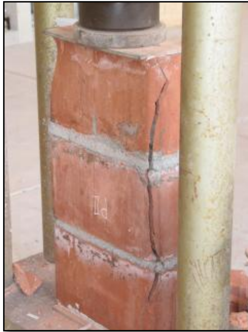
Fig. 24 Falla de la pila por compresión axial
