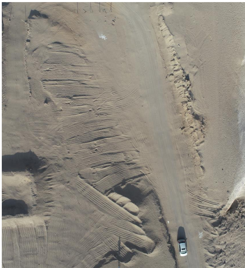
Figura 27 Tipología Demarcación de puntos de fotocontrol N°29 y N°30
