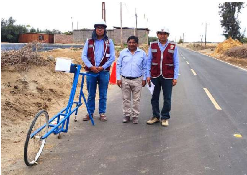
Figura 4: Ensayo con Rugosimetro de Merlin con la supervision del ingeniero asesor.
