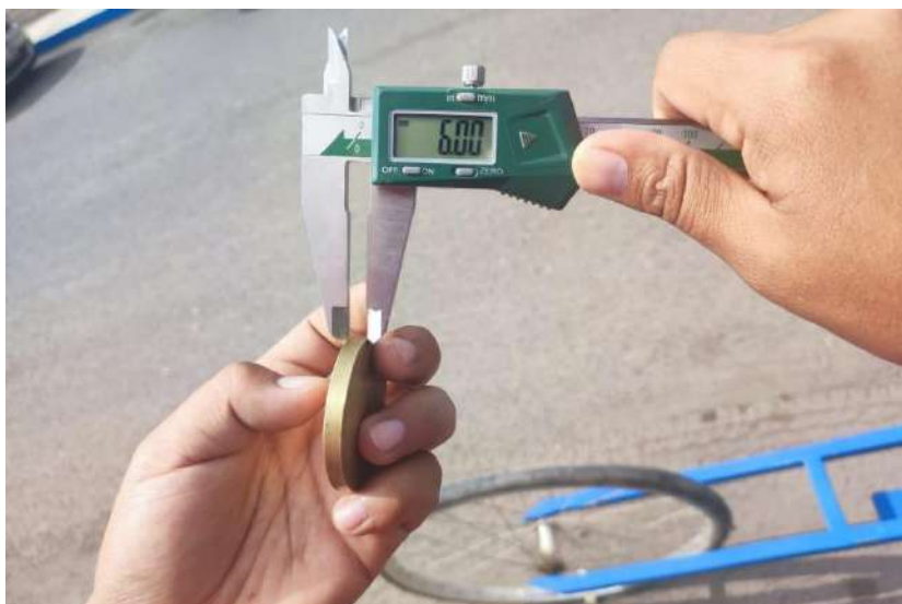
Figura 1: Calibración de Merlin con pastilla de bronce
