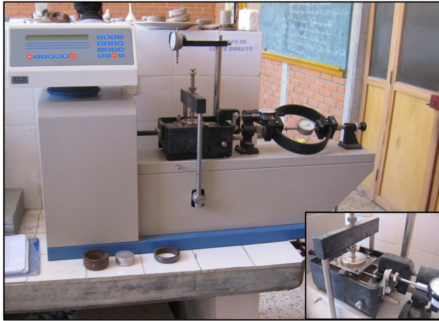
Foto 07: Ensayo de corte directo consolidado drenado.
