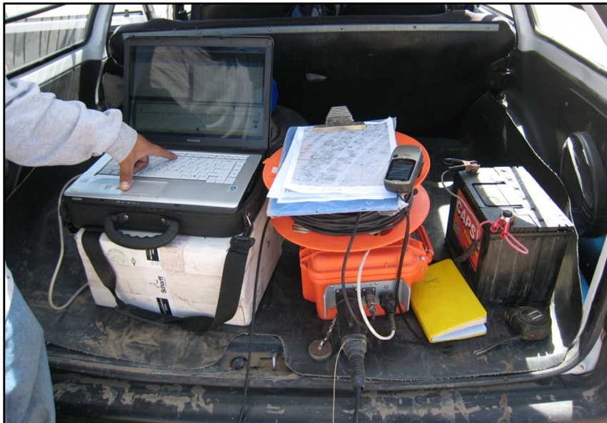
Foto 02: Adquisición de registros sísmico con sismógrafo ES-3000.
