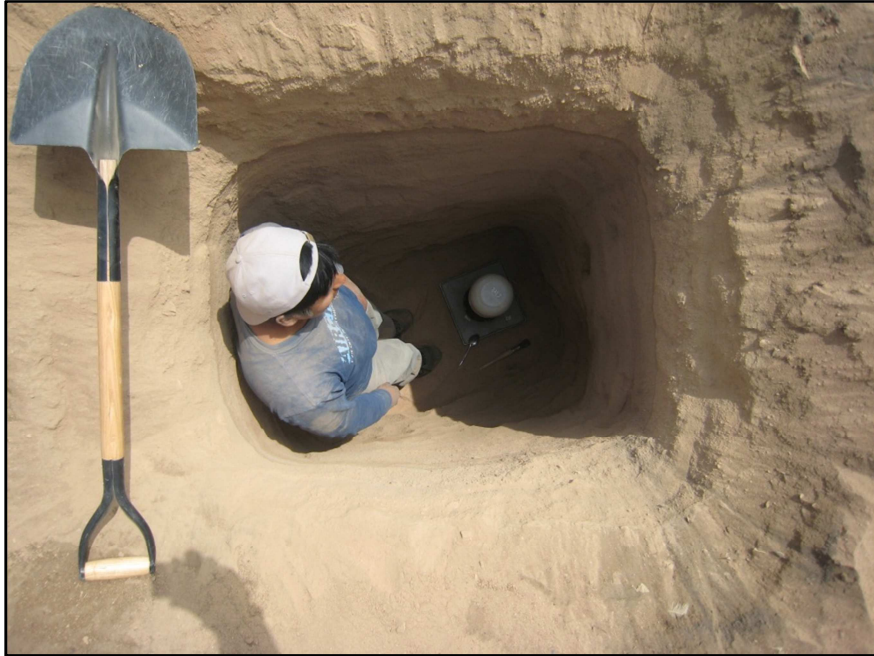
Foto 05: Ensayo para obtención de densidad del suelo por el método del cono de arena.
