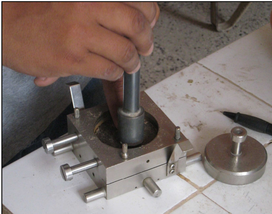
Foto 06: Remoldeo de muestra para ensayo de corte directo.
