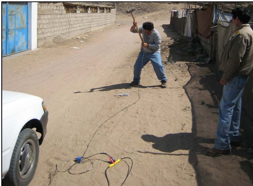
Foto 04: Generación de ondas sísmicas con comba a tres metros del primer geófono del tendido.
