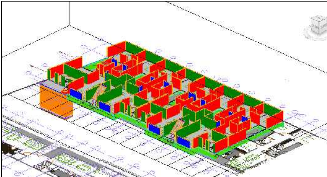
Figura 24. Modelamiento paramétrico de muros (Bloque A,B)
