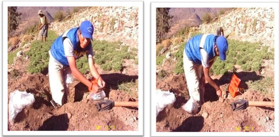
Fotos 12 y 13: Descripción física y recolección de muestras de suelos sector Sirca – Tarata.
