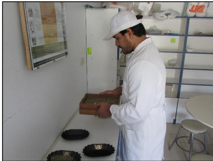
Figura 15,1. Análisis de granulometría del café verde con malla nro. 14, separando los cafés debajo de este.
