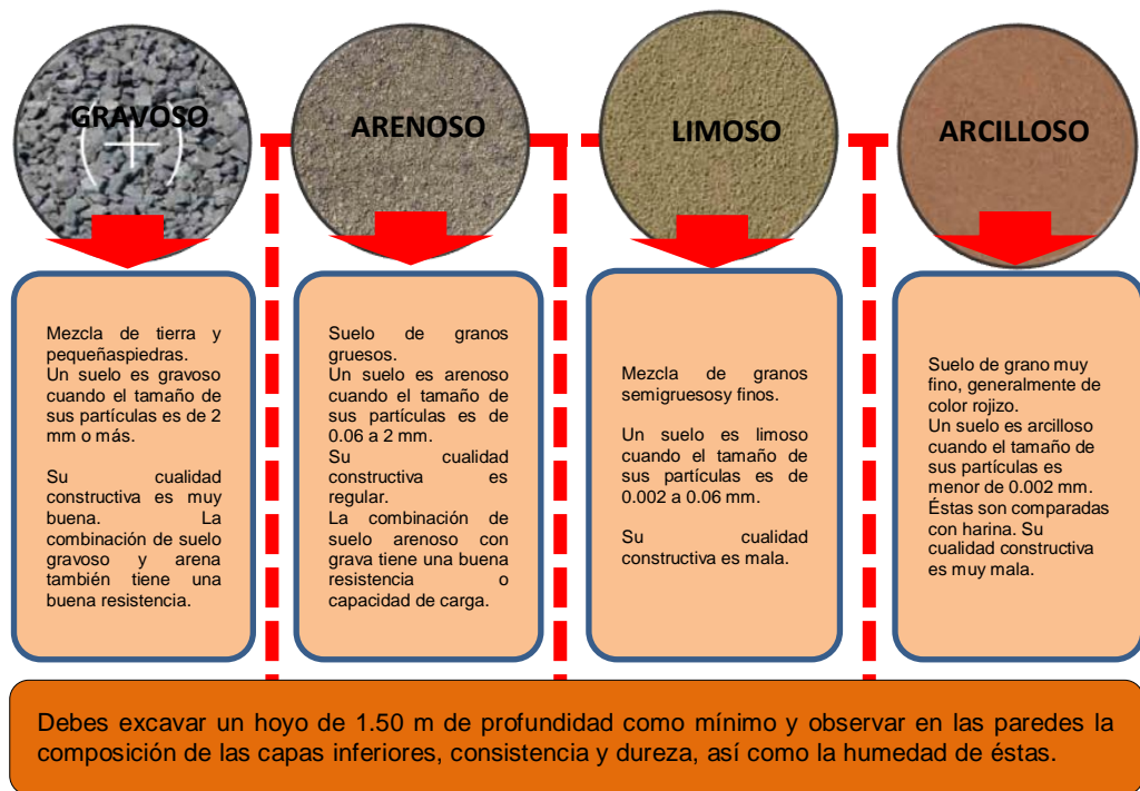
Figura 67. Propiedades óptimas del suelo para elaboración de adobes.
