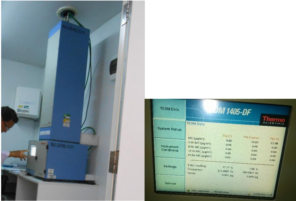
Figura 23. El equipo Thermo Scientific TEOM 1405-DF
