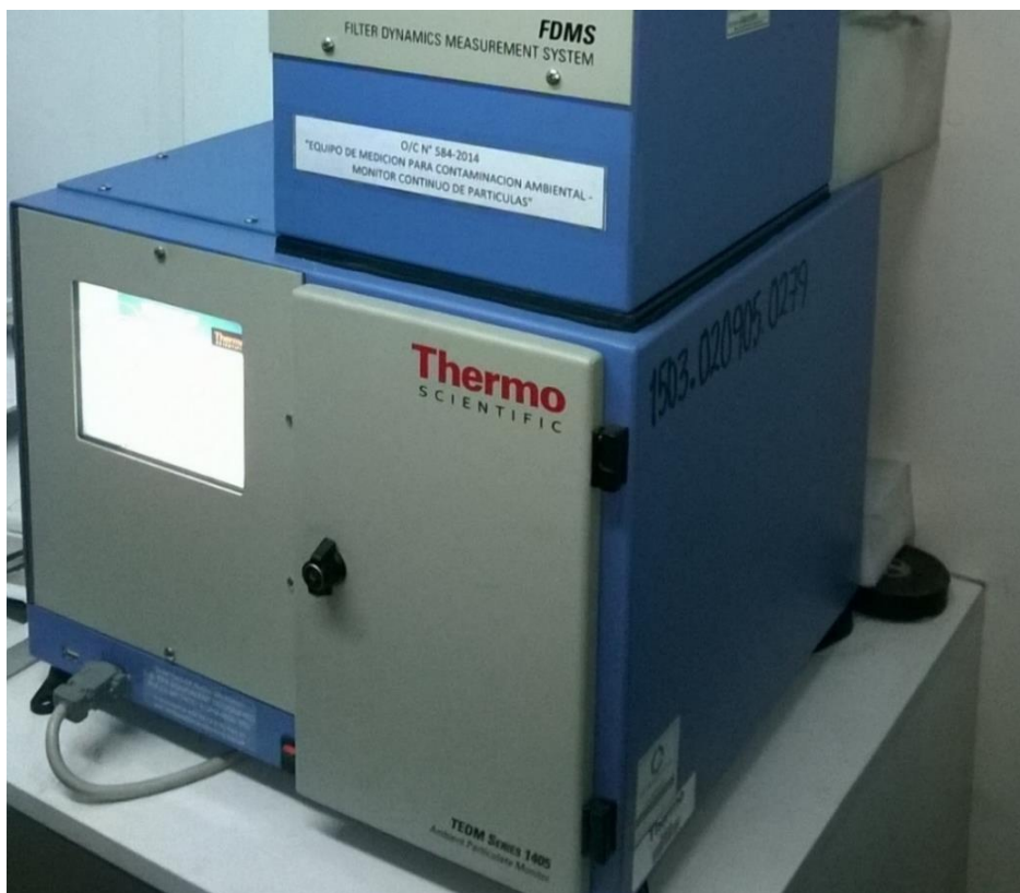
Figura 25. Equipo Thermo Scientific TEOM 1405-DF para la medición de PM 10 y PM 2,5
