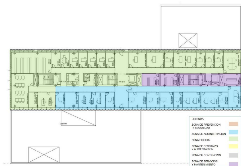
Figura N° 19: Zonificación planta típica segundo, tercer y cuarto piso proyecto Jefatura Superior de Policía en Logroño
