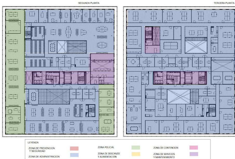
Diagrama de zonificación de la segunda y tercera planta infraestructura policial - POLITIECOMMISSARIAAT BRUGGE
