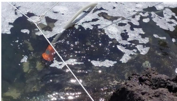
Figura 7 Extracción de agua de mar con bomba sumergible
