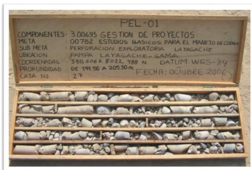
Foto N° 08. Testigos del Taladro PEL-01, unidad Conglomerado Los Molles, constituido conglomerados gruesos, fragmentados, y saturados, en este depósito está emplazado el acuífero confinado.
