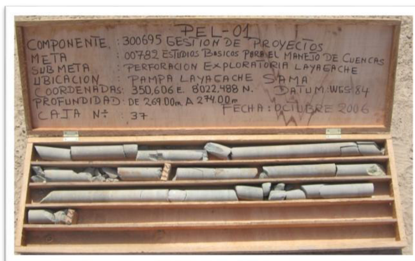
Foto N° 09. Testigos del Taladro Diamantino PEL-01, Formación Moquegua Inferior constituida por areniscas de color gris, estas rocas conforman el basamento impermeable del acuífero.
