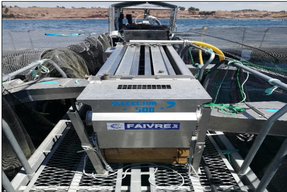
Anexo 16. Seleccionador y contadores automáticos
